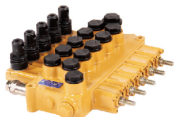
ZDaG-15 系列整体式多路阀 MONOBLOCK VALVE 公称压力 NOMINAL PRESSURE : 20MPa 公称流量 NOMINAL FLOW RATE : 50L/min 阀杆行程 SPOOL STROKE : 5+5mm
