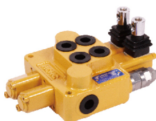
ZDG-15 系列整体式多路阀 MONOBLOCK VALVE 公称压力 NOMINAL PRESSURE : 20MPa 公称流量 NOMINAL FLOW RATE : 50L/min 阀杆行程 SPOOL STROKE : 5+5mm
