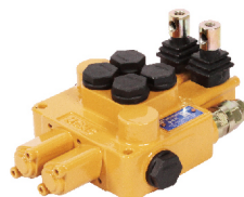
ZD*-10 系列整体式多路阀 MONOBLOCK VALVE 公称压力 NOMINAL PRESSURE : 20MPa 公称流量 NOMINAL FLOW RATE : 40L/min 阀杆行程 SPOOL STROKE : 5+5mm
