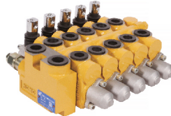
DL*-15 系列多路换向阀 DIRECTIONAL VALVE 公称压力 NOMINAL PRESSURE : 20MPa 公称流量 NOMINAL FLOW RATE : 65L/min 阀杆行程 SPOOL STROKE : 7+7mm
