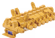
EDL*-10 系列多路换向阀 DIRECTIONAL VALVE 公称压力 NOMINAL PRESSURE : 20MPa 公称流量 NOMINAL FLOW RATE : 40L/min 阀杆行程 SPOOL STROKE : 5+5mm
