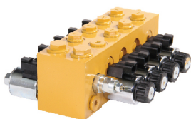
DCF 系列多路换向阀 DIRECTIONAL VALVE 公称压力 NOMINAL PRESSURE : 31.5MPa 公称流量 NOMINAL FLOW RATE : 50L/min 控制电压 SPOOL STROKE : DC24V/DC12V
