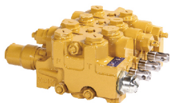
DF28-15 系列多路换向阀 DIRECTIONAL VALVE 公称压力 NOMINAL PRESSURE : 25MPa 公称流量 NOMINAL FLOW RATE : 50L/min 阀杆行程 SPOOL STROKE : O型 5+5mm Q型 6.5+6.5+4mm 阀蕊直径 THE VALVE CORE DIAMETER : \Phi 19
