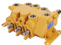
DLS*-15 系列多路换向阀 DIRECTIONAL VALVE 公称压力 NOMINAL PRESSURE : 20MPa 公称流量 NOMINAL FLOW RATE : 50L/min 阀杆行程 SPOOL STROKE : 7.5+7.5mm
