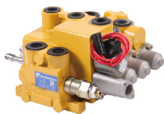
DCDB*-15 系列多路换向阀 DIRECTIONAL VALVE 公称压力 NOMINAL PRESSURE : 20MPa 公称流量 NOMINAL FLOW RATE : 65L/min 阀杆行程 SPOOL STROKE : 7+7mm
