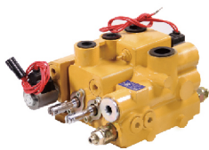
CDC*-15 系列多路换向阀 DIRECTIONAL VALVE 公称压力 NOMINAL PRESSURE : 20MPa 公称流量 NOMINAL FLOW RATE : 65L/min 阀杆行程 SPOOL STROKE : 7+7mm
